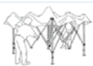
脚台座を足で踏み押さえながら支柱をスライドさせ、支柱を高めます。写真のように支柱は平行に持ち上げてスライドしてください。5段階調整が可能です。▶ コツ④
